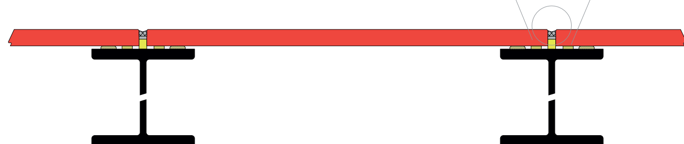
PANNEAU PLANCHERS DE BALCON FIXÉ SUR POUTRE EN ACIER (COLLÉ)
