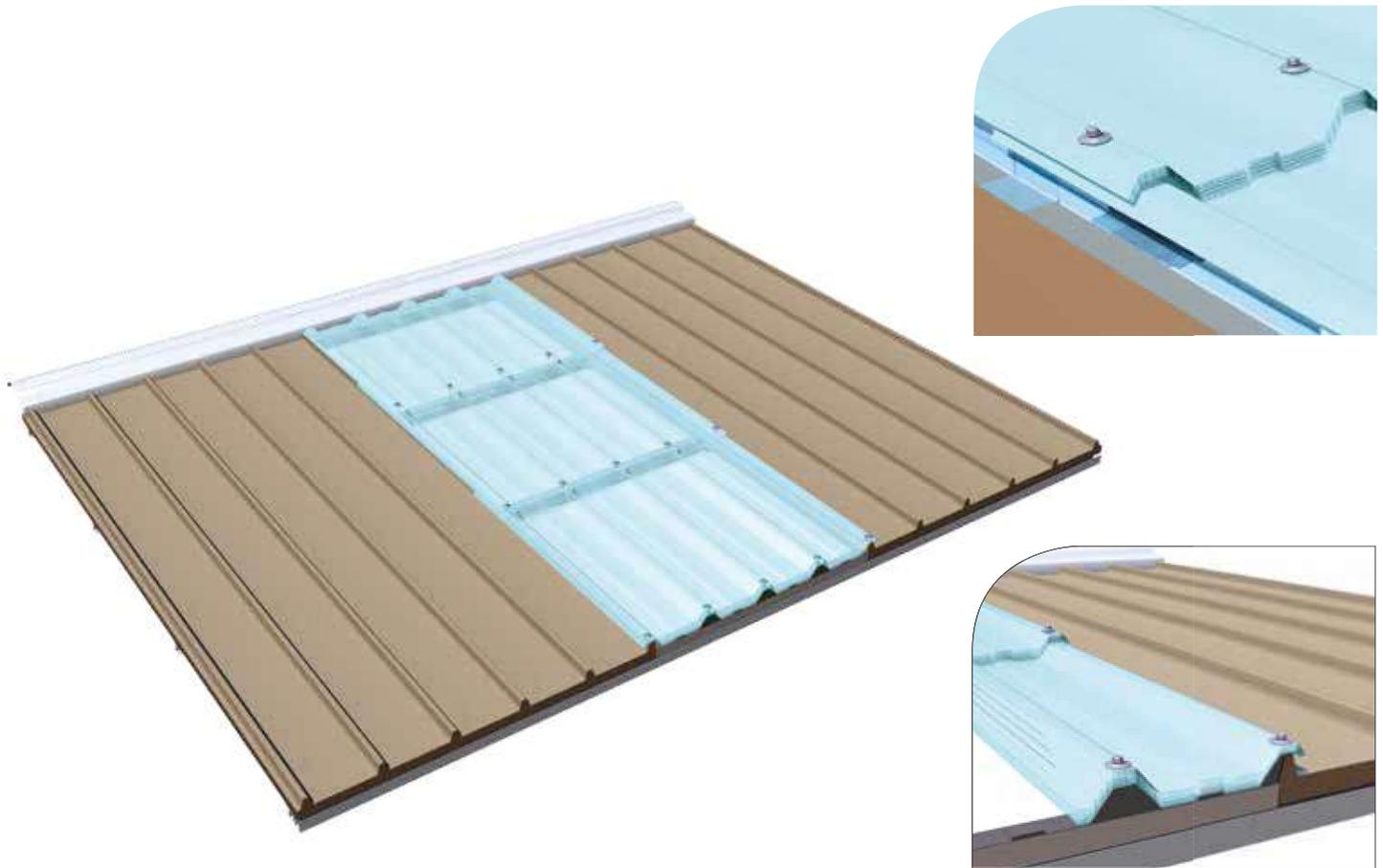
• Vue détaillée fixation et recouvrement latéral avec Grecatec® 250/40/25 mm
