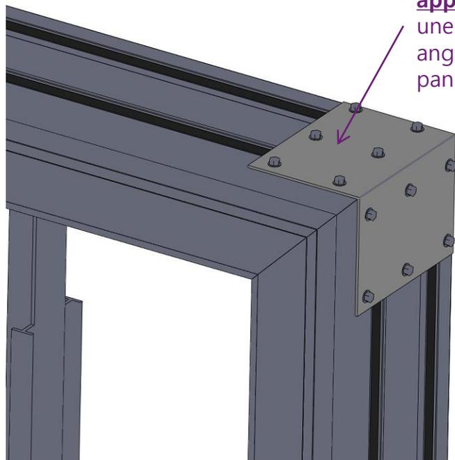
Nous préconisons, **lors de pose en applique uniquement**, de rajouter une équerre de renfort dans les angles avant la mise en place des panneaux polycarbonate.
