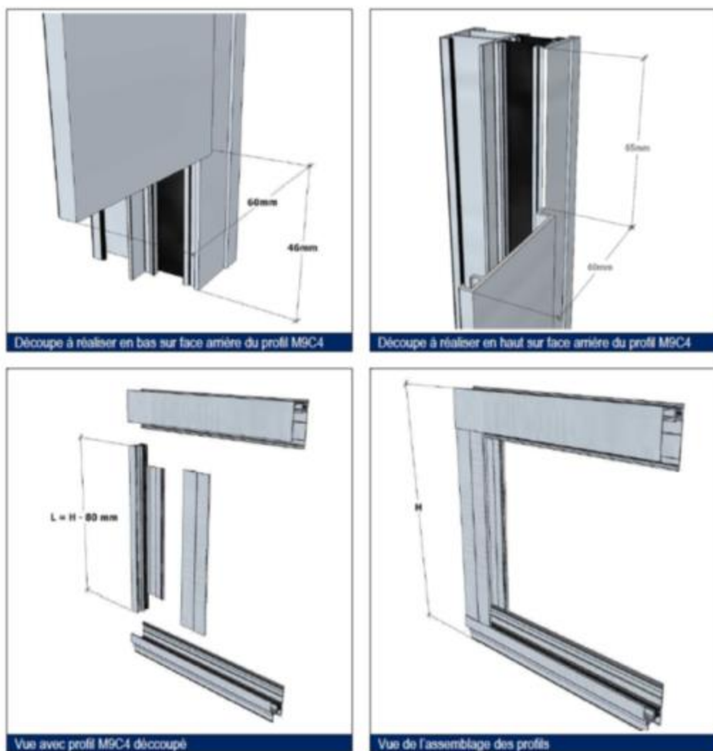
Figure 38 - Grueage des profils à rupture de pont thermique
