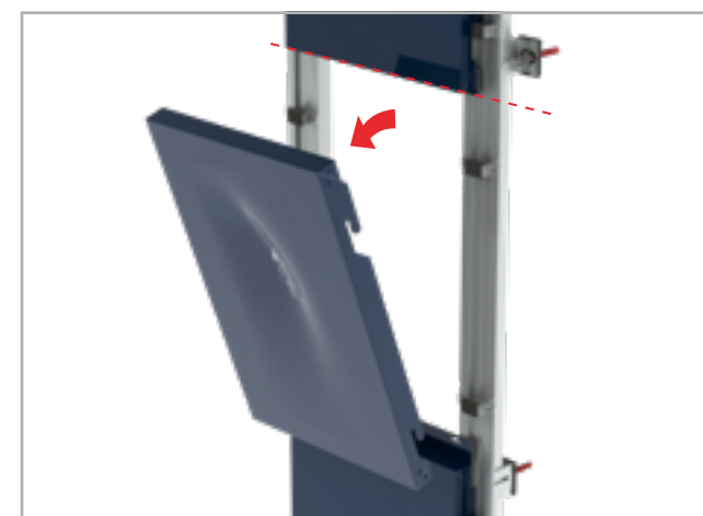
1. Retirer la cassette endommagée en coupant par le rebord supérieur.
